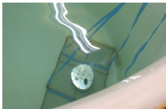
IPX8 試験の様子 (1.6m 30 分間の浸水)
